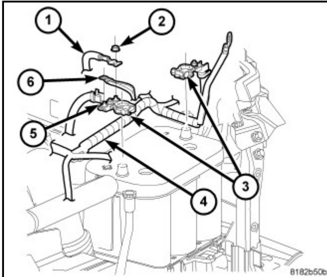
3. 松开将蓄电池固定在托盘(3)上的螺栓(1)和固定件(2)。
